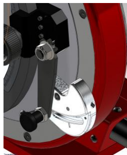
Az előfeszítés miatt tökéletesen követi a csőalakját
